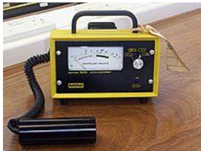
Trabaja a diferencias de potencial mucho mayor que la cámara de ionización, la ionización secundaria es tan grande que todo el gas del tubo queda ionizado.
