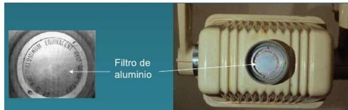
Hay que tener en cuenta la filtración intrínseca del equipo de rayos que está dada por el vidrio del tubo de rayo, el aceite aislante y la cubierta que rodea al aceite. Esto equivale a 0,5 mm de aluminio en los aparato de uso odontológico.
